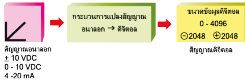
รูปที่ 2.16 ไดอะแกรมการส่งข้อมูลอนาลอกให้ PLC (ที่มา: วชิระ, 2556)
