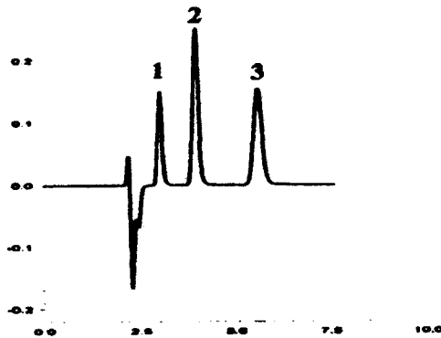
รูปภาพ 4.4 โครมาโทแกรมของสารละลายมาตรฐานอาร์บูติน (1) ไฮโดรควิโนน (2) และเรเซอร์ซินอล (3) เมื่อใช้ Brij 35 ที่ความเข้มข้น 0.6 มิลลิโมลาร์ ที่พีเอช 7 เป็นวัฏภาคเคลื่อนที่
